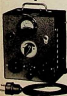
für Werkstatt und Kundendienst, Leistung: 300 VA, Pr. 110/125/150/220/240 V durch Schalter an d. Frontplatte umstellbar, Sek. 180-260 V in 15 Stufen regelbar mit Glühlampe und Sicherung. Dieser Transformator schaltet beim Regelvorgang nicht ab, daher keine Beschädigung d. Fernsehgerätes.
