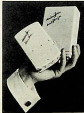
Bild 3. Minifon-Taschensender und -empfänger für drahtlose Tonbandbesprechung
