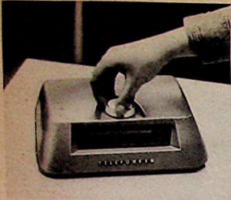
Bild 6. Telefunken-Dezi-Konverter zum Aufstellen auf dem Fernsehempfänger
