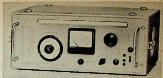
Bild 13. Selektives Millivoltmeter für Fernsehband IV von Rohde & Schwarz
