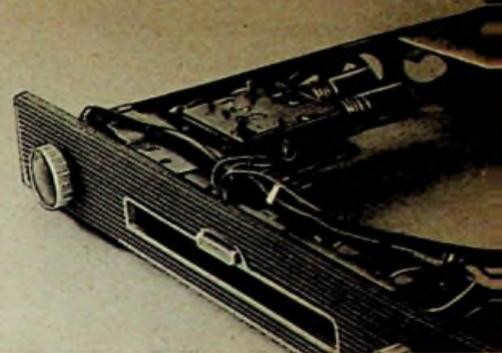
Bild 2. Anordnung des Dezi-Tuners in einem der neuen Nordmende-Fernseh-Chassis mit Dezi-Skala
